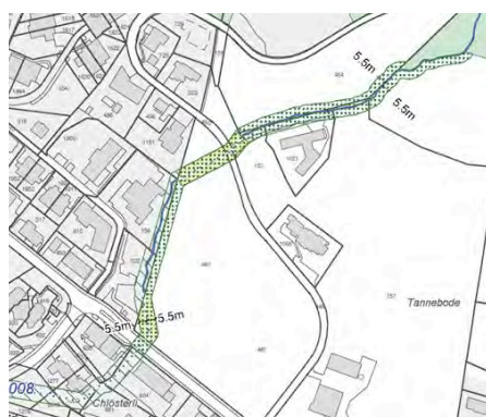
Auszug aus dem Plan Teilrevision Ortsplanung Festlegung Gewässerraum am Beispiel des Mühlebachs
