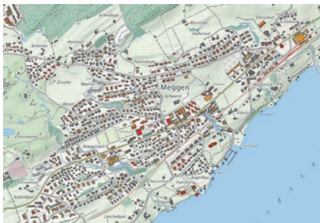
Auf dem Kartenausschnitt sind Gebäude rot und gelb markiert, welche für die Installation einer Photovoltaikanlage geeignet sind.
