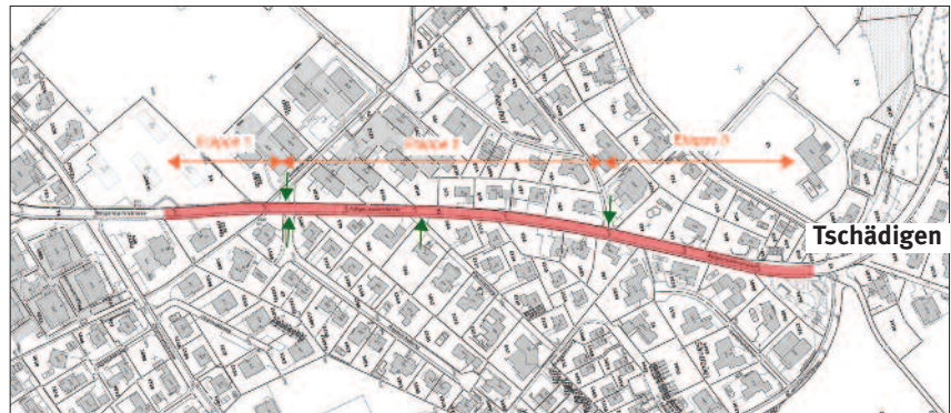
Der Einbau des Deckbelages erfolgt zwischen Obermatt und Tschädigen in drei Etappen.
