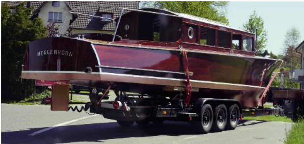
Kein alltägliches Bild: Das Motorschiff Meggenhorn wird auf der Strasse zum Einwassern nach Luzern transportiert.
