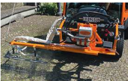
Einsatz des chemiefreien Heisswassers beim Schloss Meggenhorn.
